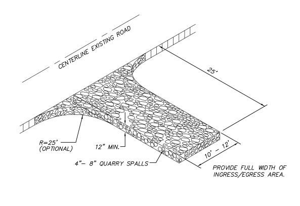
DRIVEWAYS SHALL BE PAVED TO THE EDGE OF R-O-W PRIOR TO INSTALLATION OF THE CONSTRUCTION ENTRANCE TO AVOID DAMAGING OF THE ROADWAY IT IS RECOMMENDED THAT THE ENTRANCE BE CROWNED SO THAT RUNOFF DRAINS OFF THE PAD
